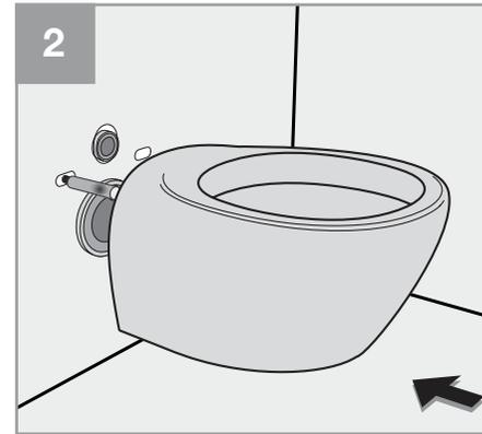
Posizionare il pezzo sui perni in acciaio. Posizionare il pezzo vicino alla parete, nel caso di bidet collegare i due flessibili del rubinetto. Spingere fino a parete facendo attenzione che tutti i raccordi si innestando perfettamente. ATTENZIONE: per agevolare l'innesto dei raccordi dell'entrata e uscita acqua si consiglia di lubrificare entrambe le parti.
