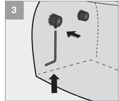
Serrare i grani con la chiave fornita nei kit avendo l'accortezza di tenere il sanitari ben accostato alla parete, facendo attenzione che sia a livello. Si consiglia di avvitare i fissaggi un pò alla volta alternando l'azione su entrambi fino al completo bloccaggio del pezzo.
